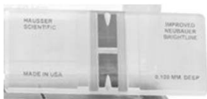
FIG. 34. Cámara de Neubauer o Hematocitómetro utilizado para el conteo de microalgas.
