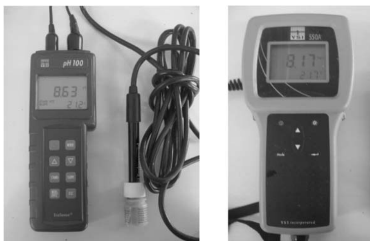
FIG. 6. Equipos portátiles para registro de pH, oxígeno y temperatura en agua.
