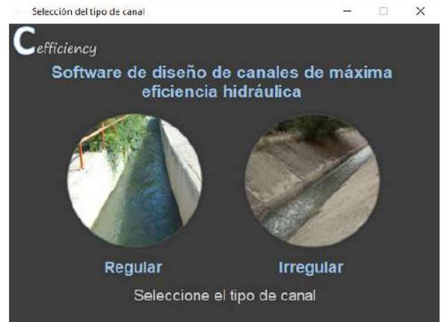
Figura 1 Pantalla principal del programa C<sub>efficiency</sub>.
